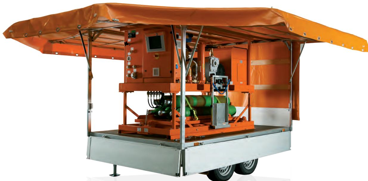
Equipo, bodega con dispositivo de pesaje incluida para 5 botellas de SF<sub>6</sub> B165R01 sobre remolque B088R11
