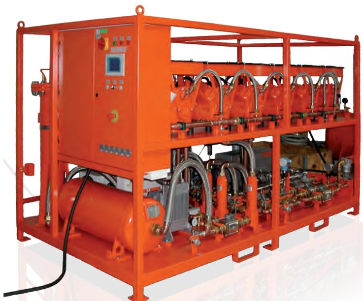
**Instalación de tratamiento de gas SF<sub>6</sub> para un canal de turbulencia a presión de gas SF<sub>6</sub> con control remoto para operación local**
