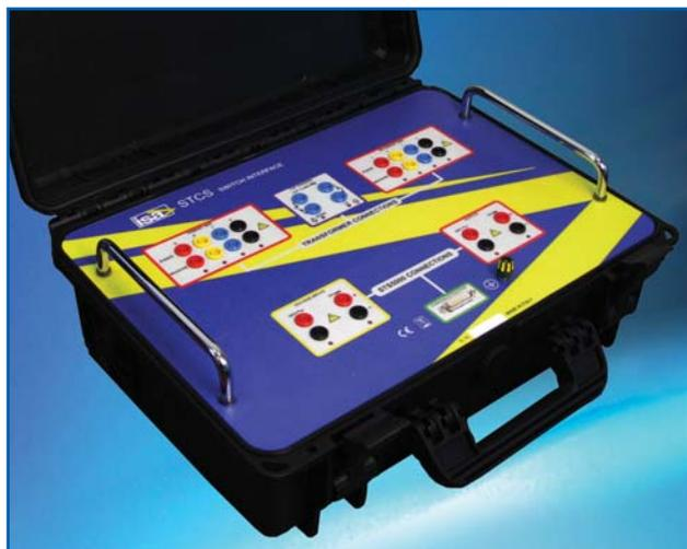
El módulo externo STCS permite realizarlas de forma automática. La conexión a las fases del transformador a ensayar (y al STS 5000) se lleva a cabo sólo una vez; así todas las pruebas se realizan sin interrupción. Durante la prueba, cuando se prueban las tomas, el equipo emite el comando correspondiente al conmutador de tomas (o al cambiador de tomas en carga), por lo que también las mediciones de relación de transformación quedan automatizadas.
